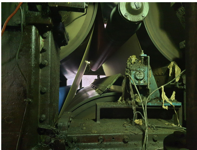
Fig. 4. Photographie d'un palier de râcle d'une sécherie et de son circuit de graissage automatisé. Crédits photographiques : Gilfor SA.
