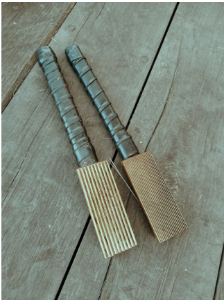
Fig. 3. Marteaux traditionnels en laiton utilisés pour battre le liber. Crédits photographiques : Maël Sébille.
