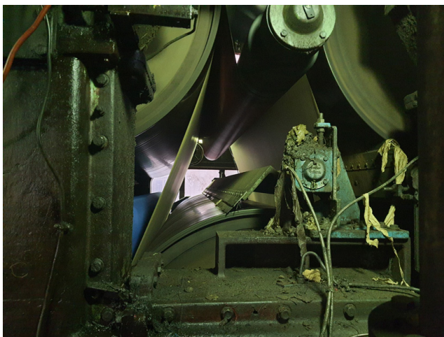
Fig. 4. Photographie d'un palier de râcle d'une sécherie et de son circuit de graissage automatisé. Crédits photographiques : Gilfor SA.
