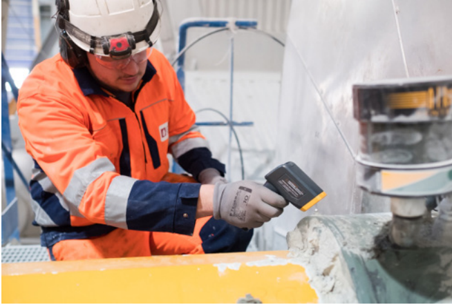
Fig. 6. Prise de mesure de température d'un palier avec un thermomètre laser. Crédits photographiques : Gilfor SA.
