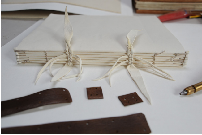
Fig. 7. Modèle de reliure en cours de fabrication, corps d'ouvrage cousu sur deux supports, prêt à être assemblé à la couverture, © Cédric Lelièvre.
