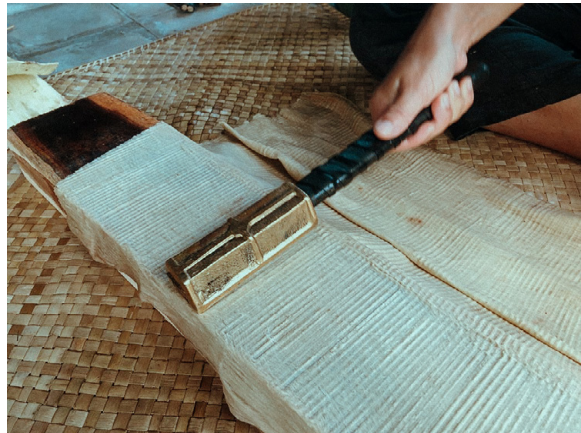
Fig. 4. Feuille de papier daluang en cours de fabrication. Crédits photographiques : Maël Sébille.
